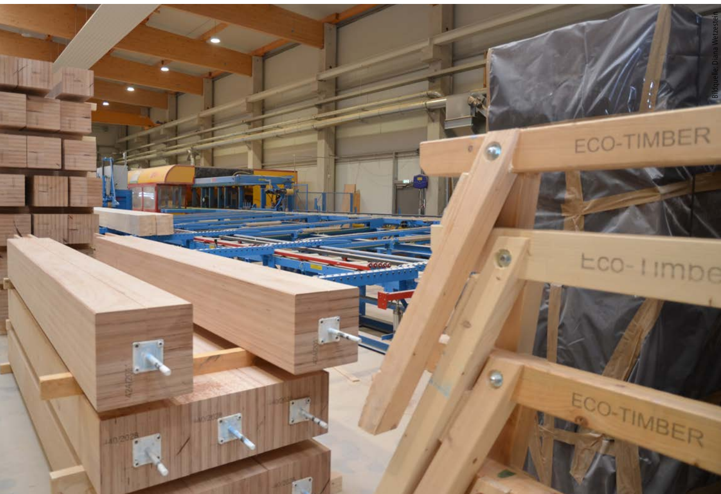
Eco Timber fertigt den BauBuche-Abbund auf der Hundegger K2 Industry 1300, hier waren es 1.200 Laufmeter.
